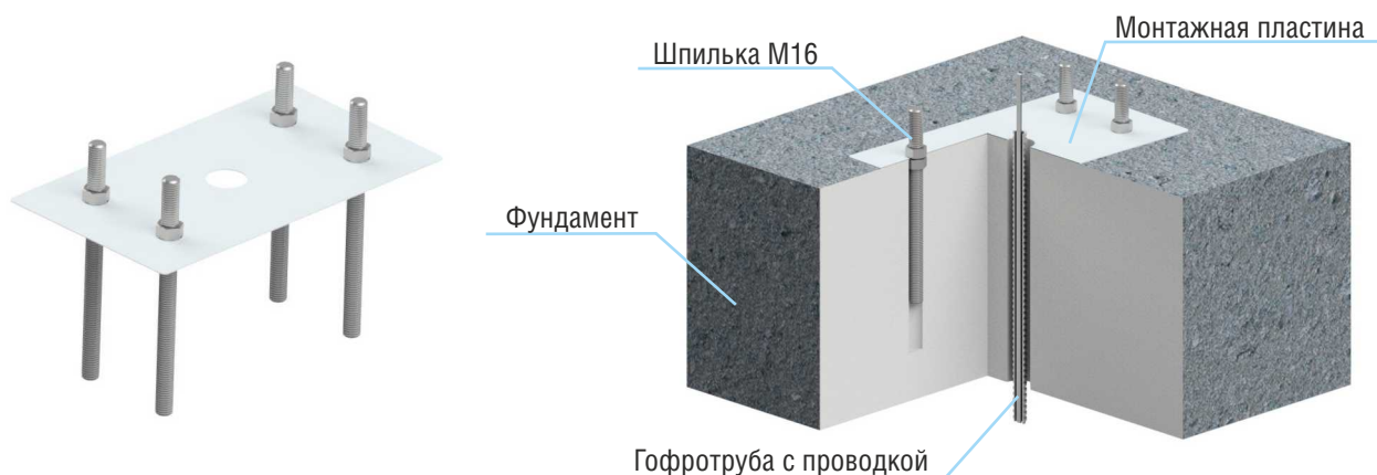
Рисунок 7.2.1 Устройство фундамента с монтажным комплектом
